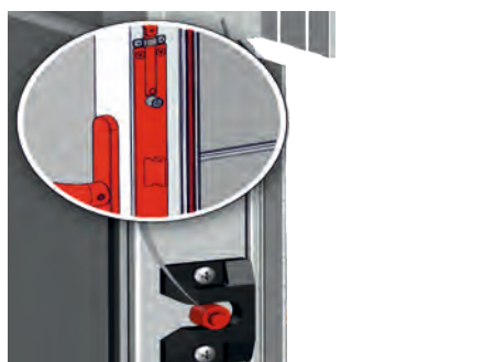
Doigts de centrage réglables par excentrique
