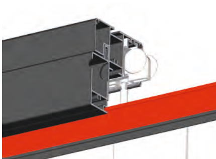
Joint d'étanchéité EPDM sur linteau
