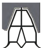
Joint bas à triple lèvre, isolation et étanchéité parfaite au sol
